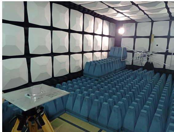
Obr. 2.4: Měření v bezodrazové komoře
