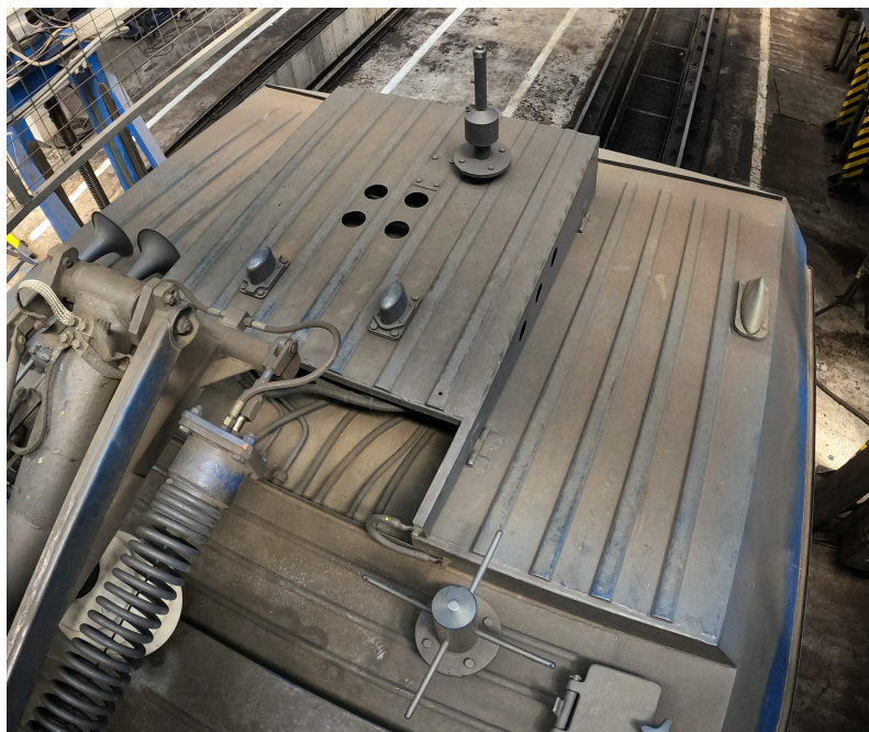
Obr. 2.1: Zástavba antén na voze 362 019 - 2
