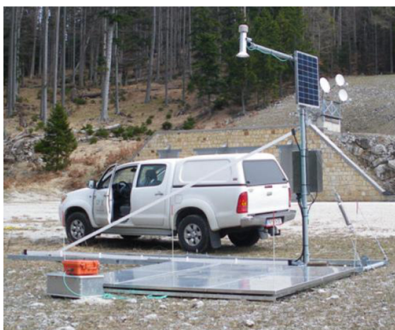
Obr. 5: Sněhoměrná váha (Sommer, 2016).
