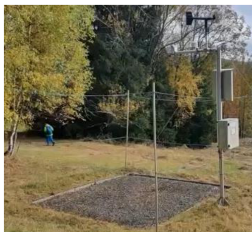
Obr. 6: Sněhoměrný polštář (ČHMÚ, 2022).
