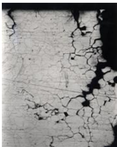
Obr. 37 Mezikrystalové korozní praskání [13]
