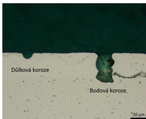
Obr. 31 Důlková a bodová koroze [4]
