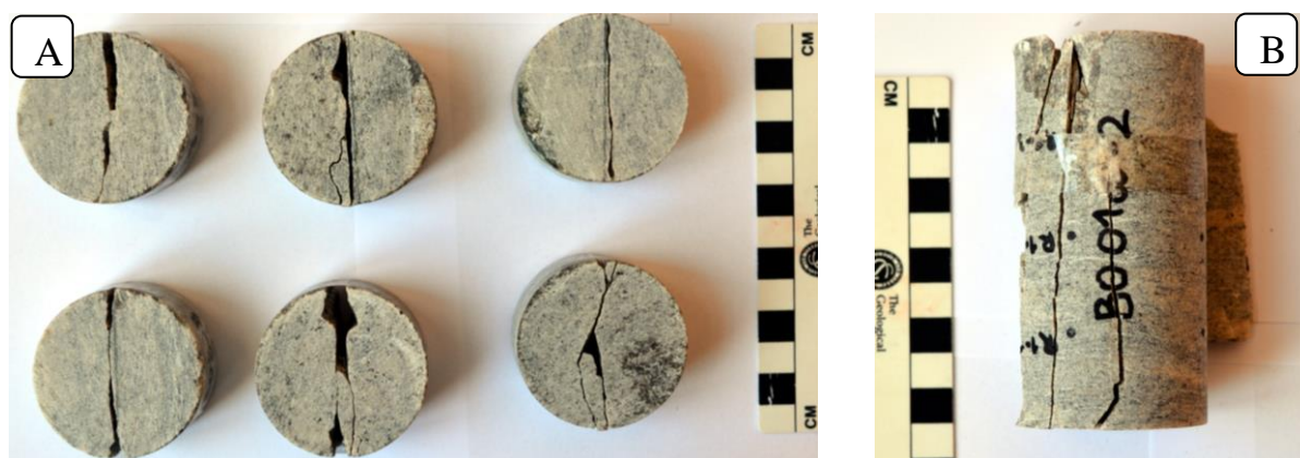
Obr. 15: A – Ukázka tahového porušení vzorků granulitu z Horních Borů. B – Ukázka křehkého porušení vzorků granulitu z Horních Borů po jednoosé zkoušce.
