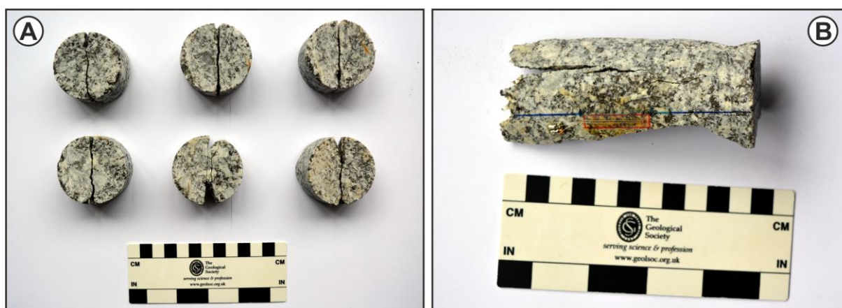
Obr. 11: A – Ukázka tahového porušení vzorků durbachitu z Kamenné. B – Porušení vzorku durbachitu z Kamenné po triaxiální zkoušce, ukázka střížných trhlin s kulisovitým uspořádáním typu en echelon (např. Davis et al. 2011).
