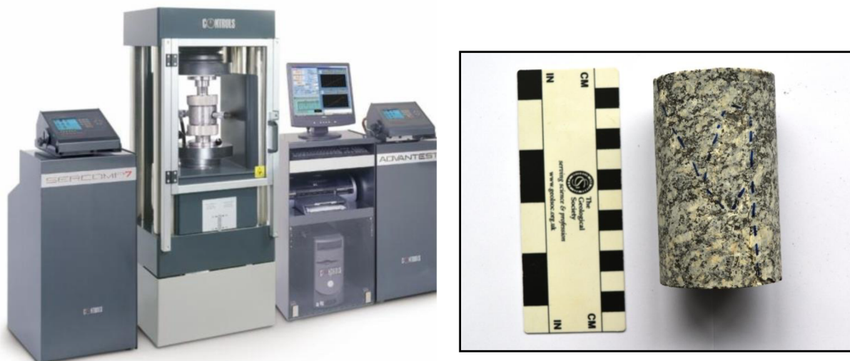
Obr. 8: A – Měřicí přístroj ADVANTEST 9 ROCK využívaný v laboratoři vědecko-výzkumného centra AdMaS. Foto: www.controls-group.com . B – Ukázka testovaného tělesa durbachitu z Kamenné.
