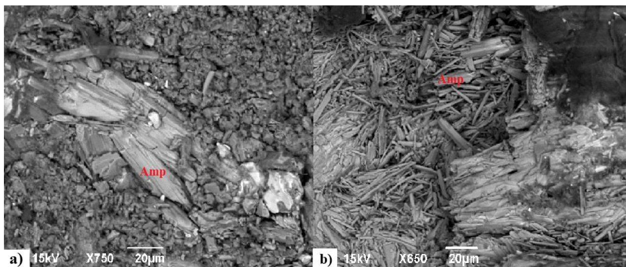
Obr. 18: Fotografie ze SEM-EDX analýzy amfibolů větší (a) a menší (b) sekerky, JEOL JSM-6490 LV (J. Štelcl 2018).
