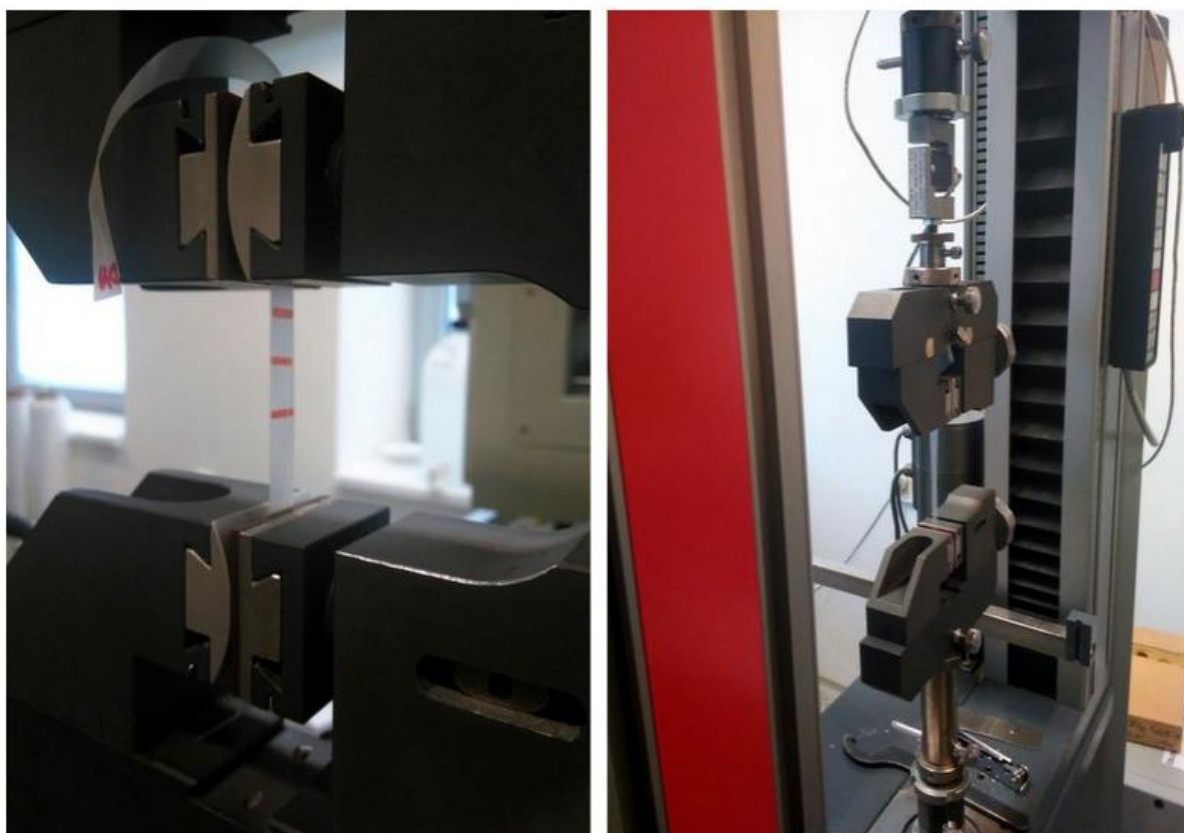
Obr. 11: Vlevo detail upnutí vzorku v čelistech, vpravo fotografie měřicí hlavy a čelistí
