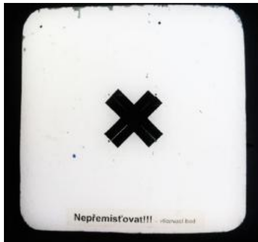
Obr. 5 - Vlícovací bod použitý pro leteckou fotogrametrii (MIKITA et al., 2016)
