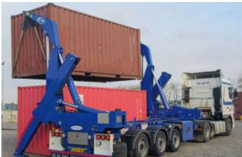
Obr. 22 - Boční silniční překladač s lanovými závěsy [30]
