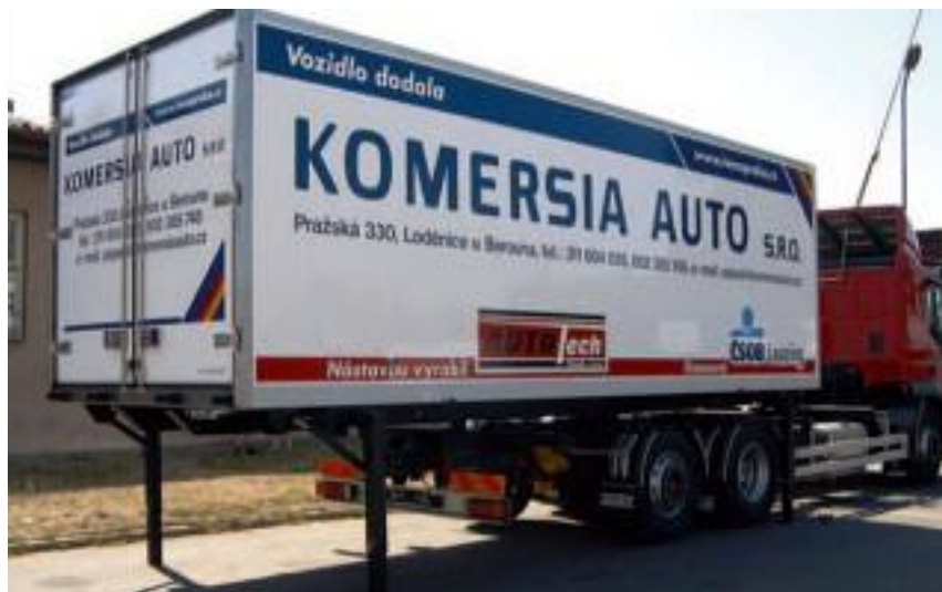
Obr. 12 - Vozidlo při odstavování výměnné nástavby [20]
