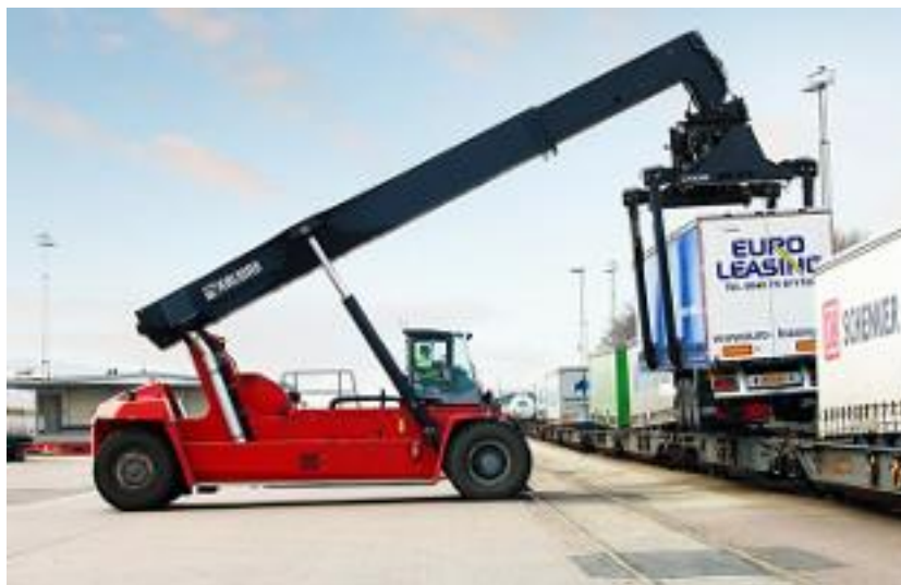
Obr. 19 - Výsuvný stohovač s kleštinami pro překládku intermodálních návěsů [27]
