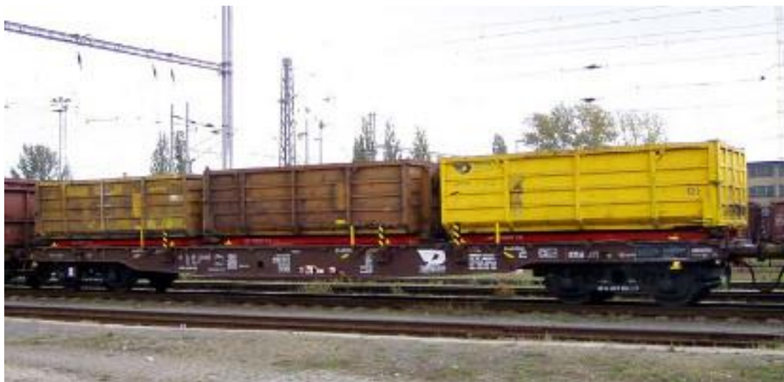
Obr. 8 - Vůz řady Slps pro přepravu odvalovacích kontejnerů [16]
