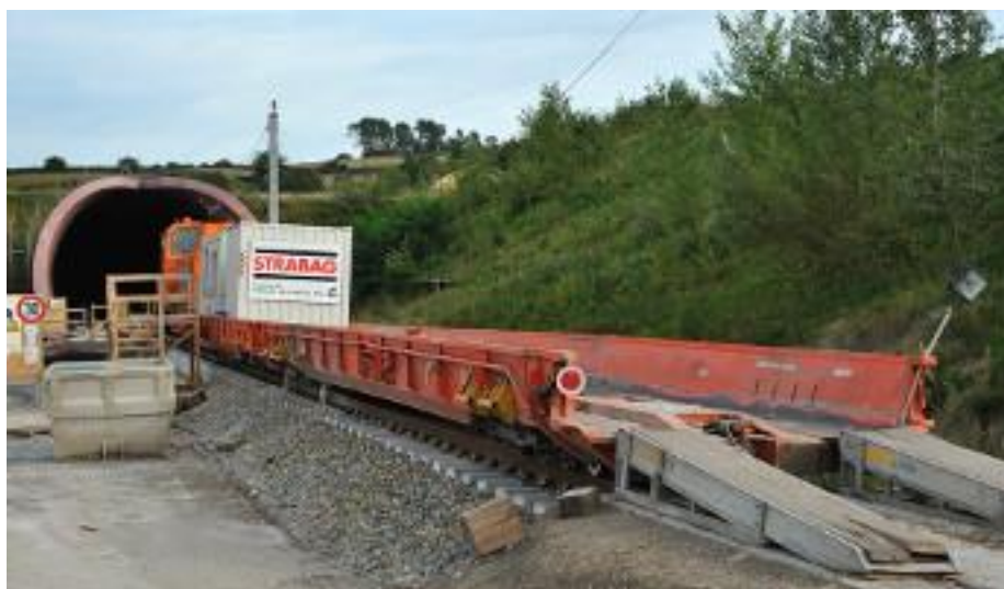
Obr. 10 - Desetinápravový vůz řady Saadkms s mobilními nájezdovými rampami [18]
