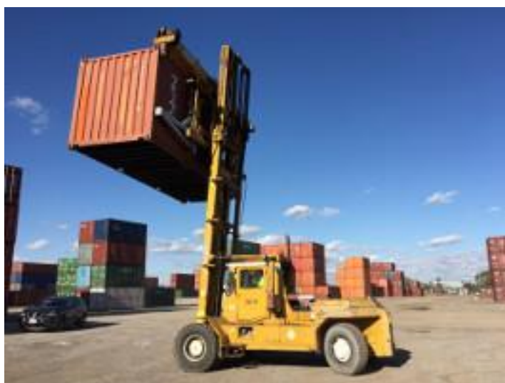
Obr. 20 - Čelní kontejnerový vůz s bočním spreadrem pro stohování prázdných kontejnerů [28]
