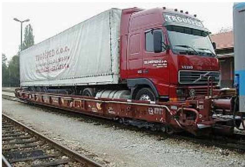
Obr. 5 - Systém Ro-La – přeprava jízdních souprav [13]
