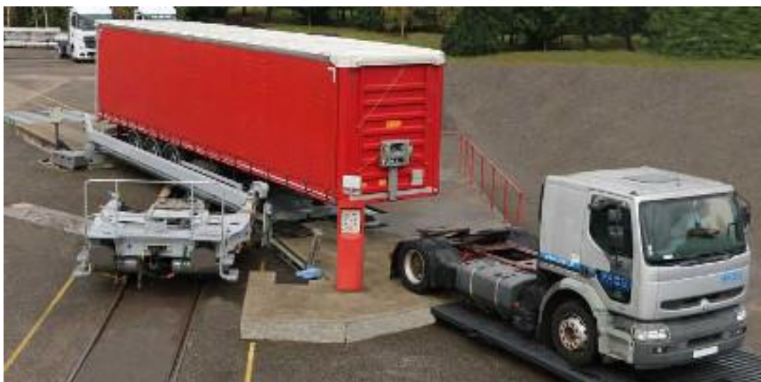
Obr. 24 - Překládka návěsu na železniční vagon Modalohr [32]
