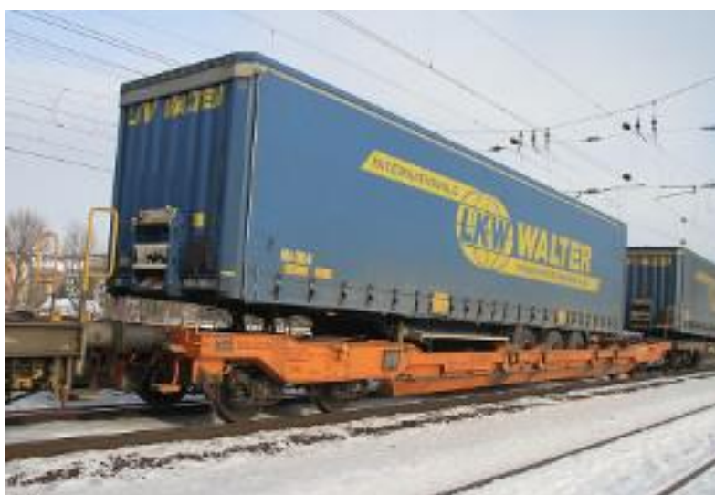
Obr. 9 - Košový vůz řady Sdgnss s přepravovaným návěsem [17]
