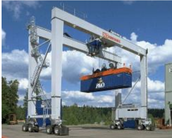
Obr. 16 - Portálový jeřáb na pneumatikách s vrchním spreadrem [24]
