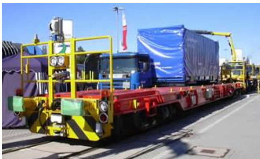
Obr. 27 - CargoMover – kamion na kolejích bez řidiče [35]
