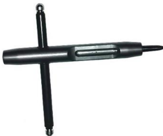
Obr. 6: Trepbor, přístroj pro odebírání mikrovývrtů
