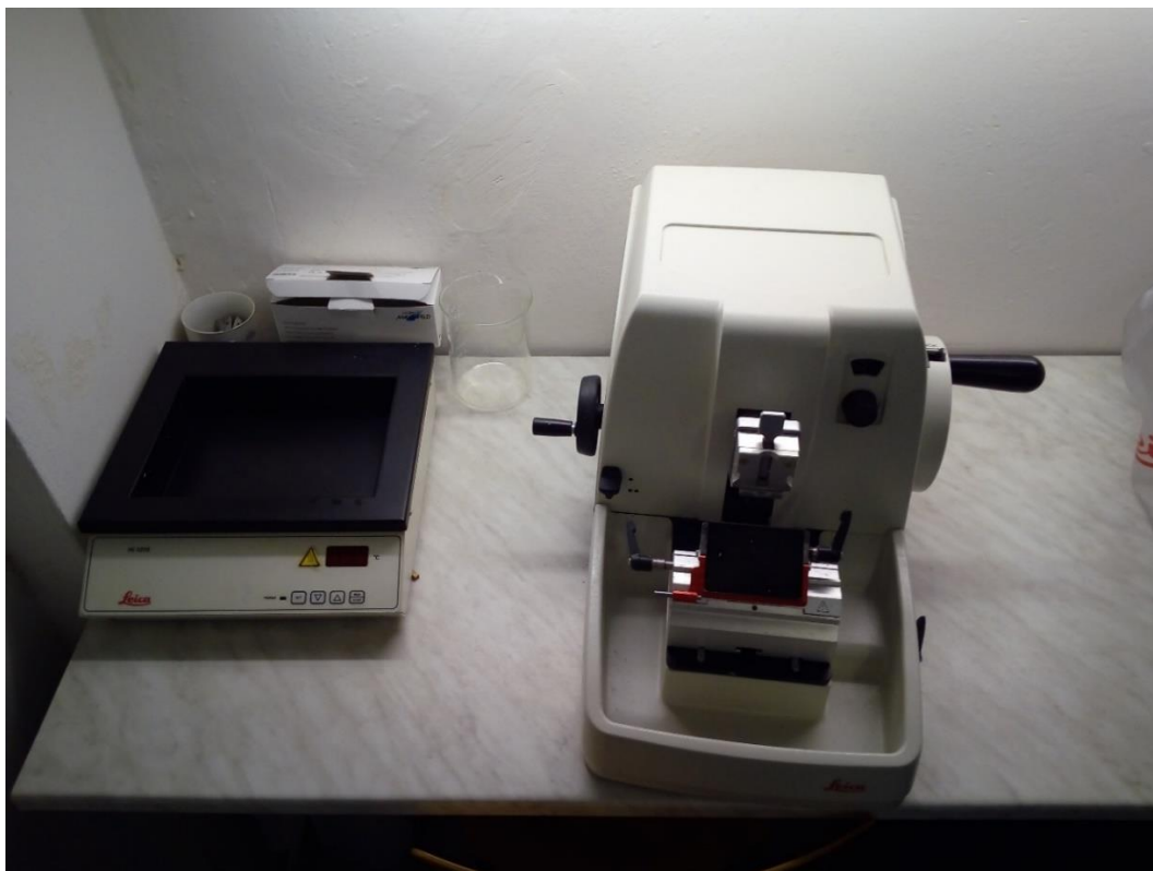
Příloha 7: Rotační mikrotom LEICA RM 2235 a vodní lázeň LEICA HI 1210
