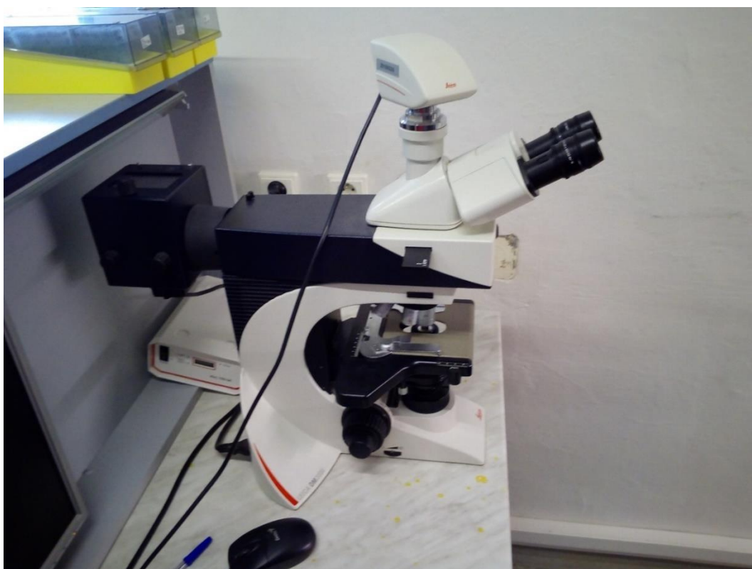
Příloha 8: Mikroskop LEICA DMLS s digitální kamerou LEICA DFC 280
