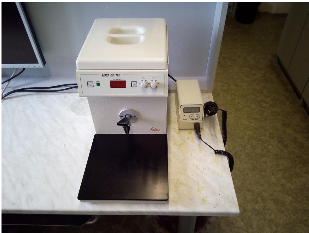
Příloha 3: Zalévací přístroj LEICA EG 1120 a elektricky vyhřívaná pinzeta LEICA EG F
