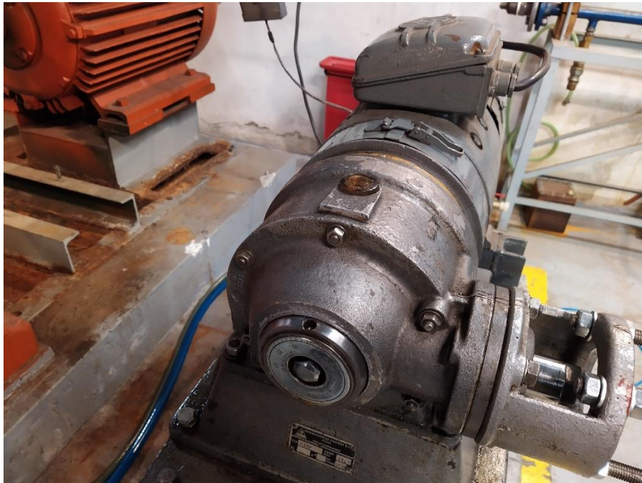
Obr. 5-24 Použitý tlakový pulsátor (hydraulický válec a motor s vačkou) [Fotografie přístroje pořízena v květnu 2021]
