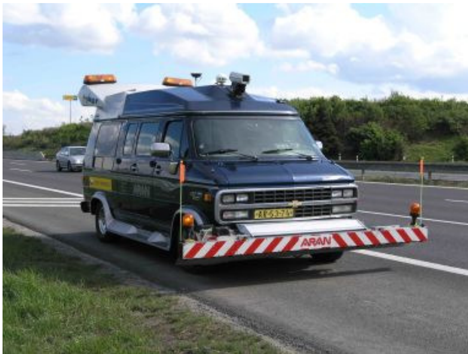
Obrázek 4.3 - Multifunkční měřicí zařízení ARAN [27]
