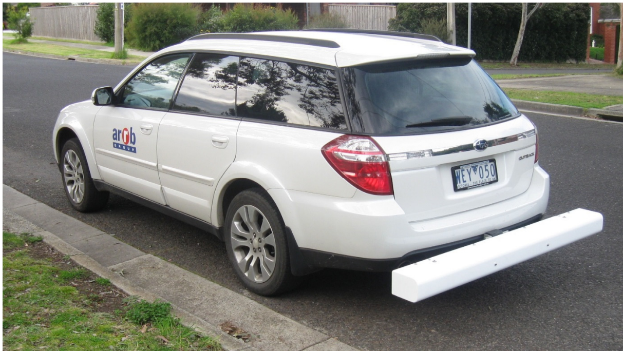
Obrázek 4.2 - Zařízení Hawkeye 1000 připevněné na osobním automobilu [24]
