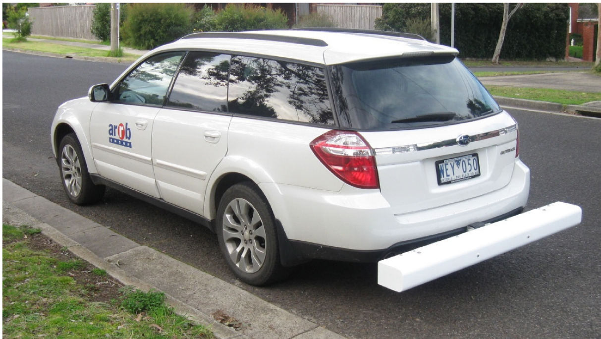
Obrázek 4.2 - Zařízení Hawkeye 1000 připevněné na osobním automobilu [24]
