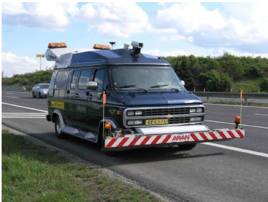
Obrázek 4.3 - Multifunkční měřicí zařízení ARAN [27]
