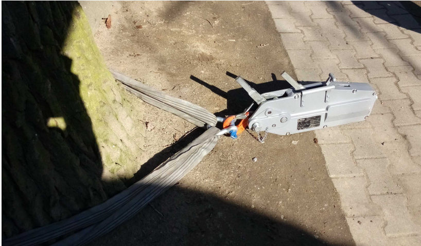
Obr. 6: Tahací zařízení (pulling machine)
