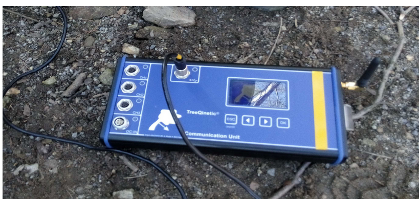
Obr. 5: Komunikační jednotka propojující počítač s měřícím systémem
