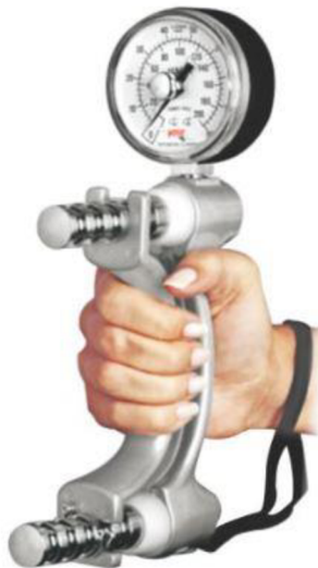
Obrázek 1: Jamar Hydraulic Hand Dynamometer
