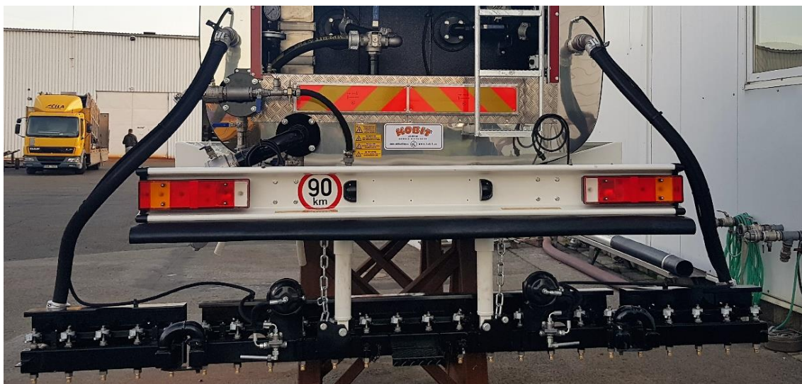
Obr 2.12 Lišta s mechanicky odklopnými rameny, hydraulicky zvedaná
