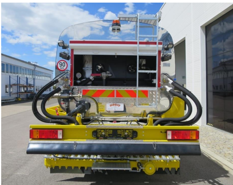
Obr. 2.8 Zadní „uzavřená“ technologie ST s emulzními rozvody
