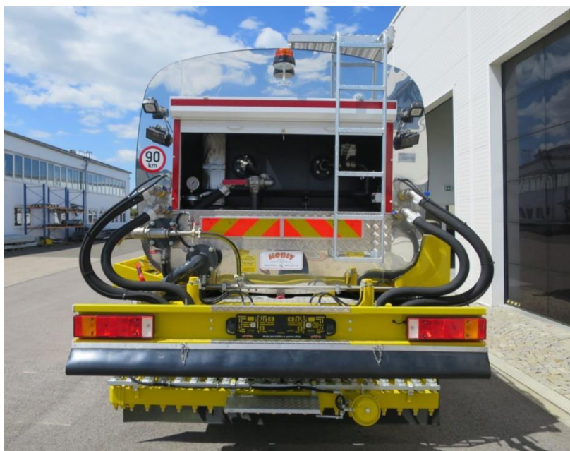
Obr. 2.8 Zadní „uzavřená“ technologie ST s emulzními rozvody
