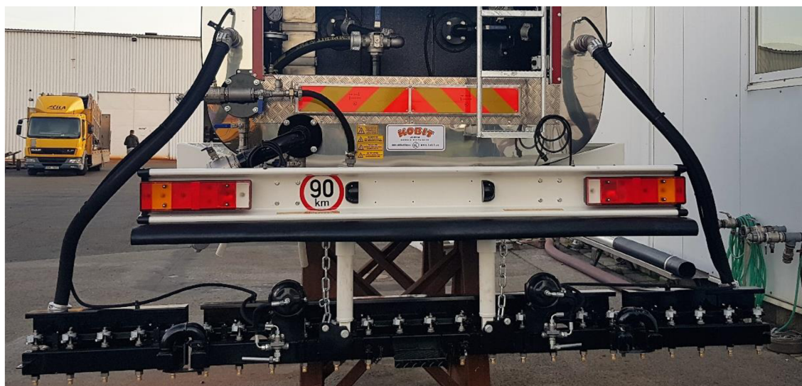
Obr 2.12 Lišta s mechanicky odklopnými rameny, hydraulicky zvedaná
