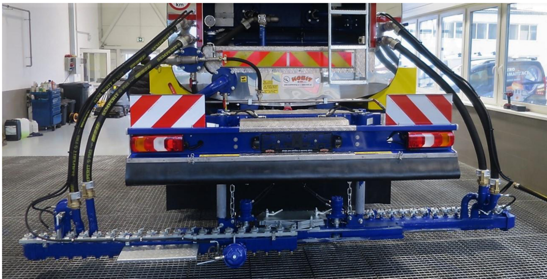
Obr 2.11 Hydraulicky rozjížděcí lišta s ozubeným pastorkem a hřebenem, hydraulicky zvedaná
