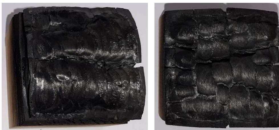
Obr. 65 Zuhelnatěná horní buková lamela K5 RPF (vlevo) a K2 PUR (vpravo)
