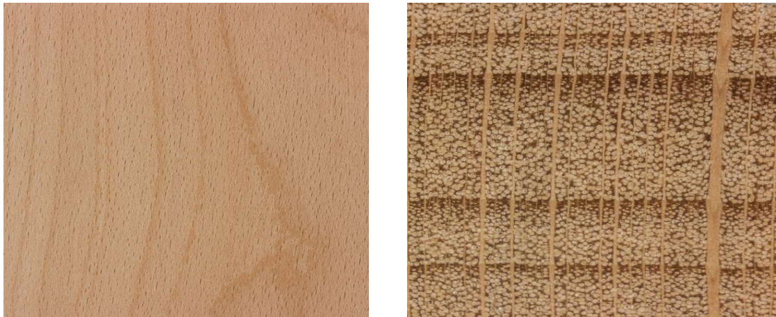
Obr. 7 Podélný řez (vlevo) a příčný řez (vpravo) bukovým dřevem (The Wood Database, 2023)
