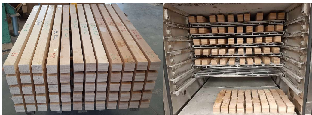
Obr. 37 Část vyrobených nosníků a jejich klimatizace
