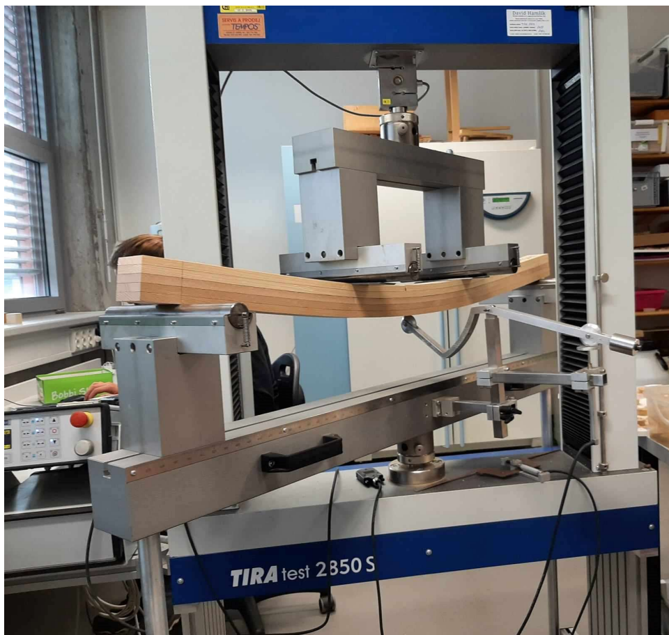
Obr. 40 Průběh ohybové zkoušky
