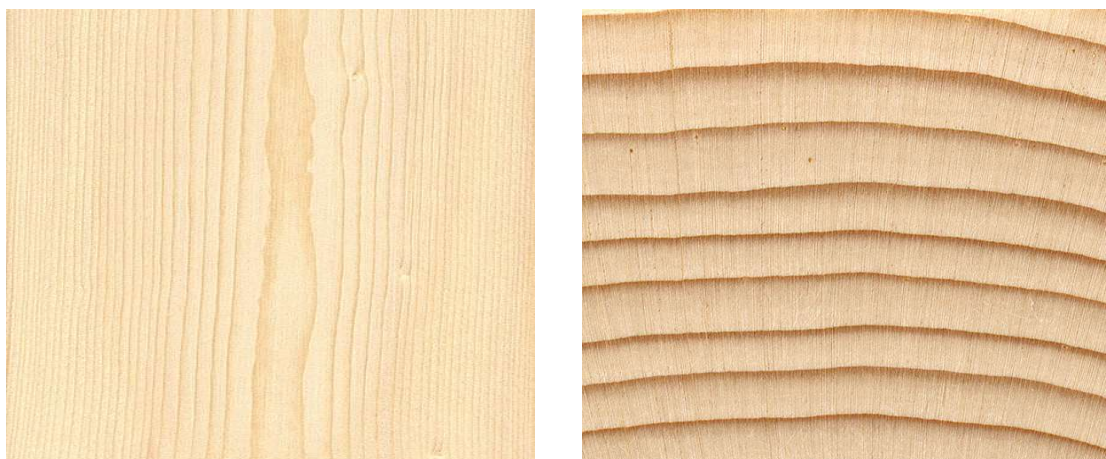
Obr. 8 Podélný řez (vlevo) a příčný řez (vpravo) smrkovým dřevem (The Wood Database, 2023)
