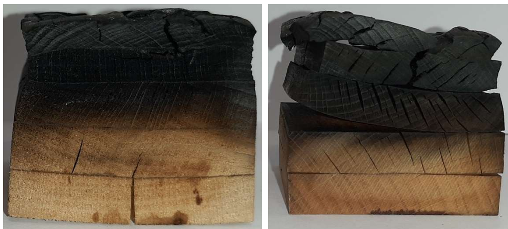
Obr. 67 Bukové dřevo lepené pomocí RPF (vlevo) a PUR (vpravo), orientace 1
