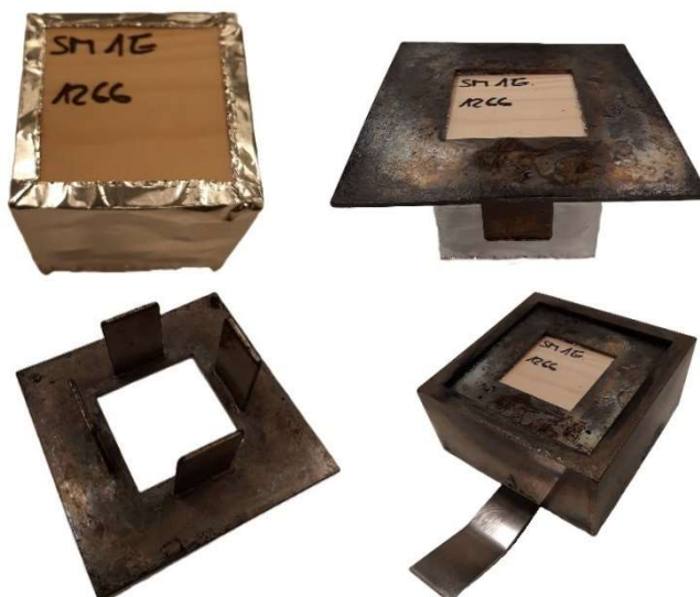
Obr. 45 Zkušební těleso v hliníkové fólii s clonou
