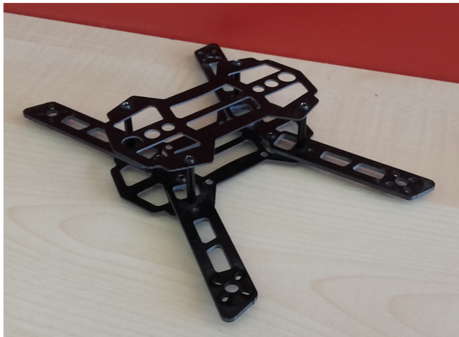
Obr. 2: Sestavený modulární sklolaminátový rám Diatone Blade 150.
