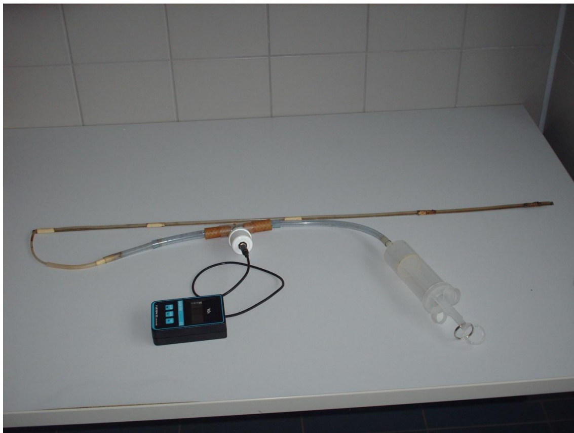
Obr. 3: Soustava pro měření koncentrace O_2 v pokusných kompostovacích zakládkách (Autor: Stejskal).
