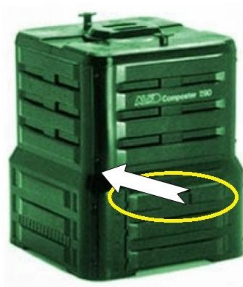
Obr. 2: Zobrazení místa měření teploty v zakládce.
