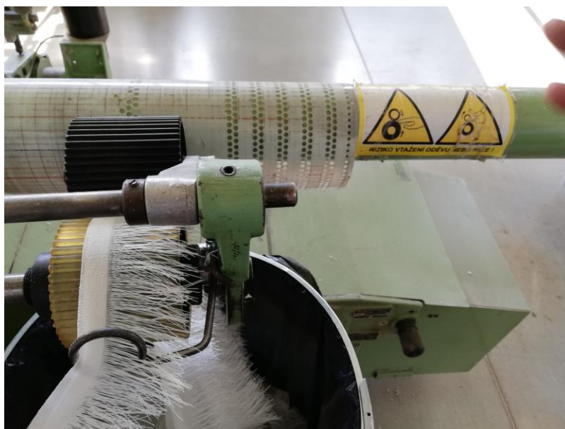
4.16 Výstražná tabulka upozorňující na nebezpečí vtažení oděvu
