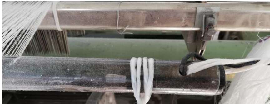
4.3 Odvod elektrostatického náboje z osnovy
