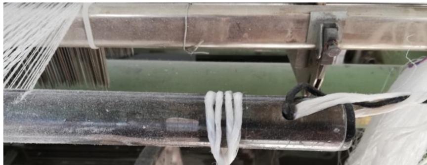
4.3 Odvod elektrostatického náboje z osnovy
