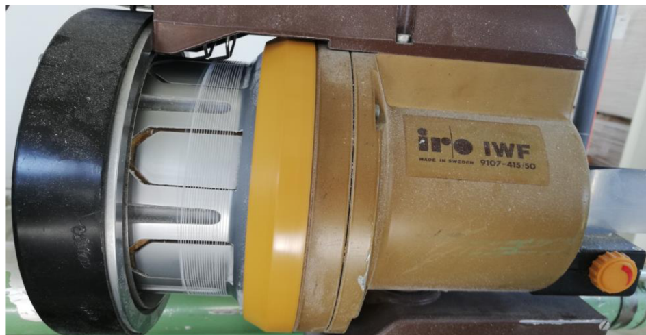
4.13 Starší typ odvíječe s mikrosřínáčovým hlídáním
