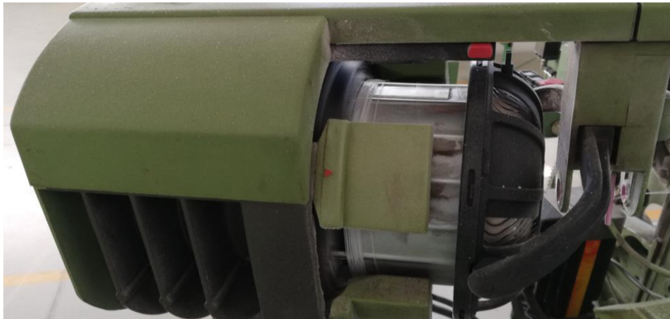
4.12 Odvíječ útkové nitě v optoelektronickém hlídání
