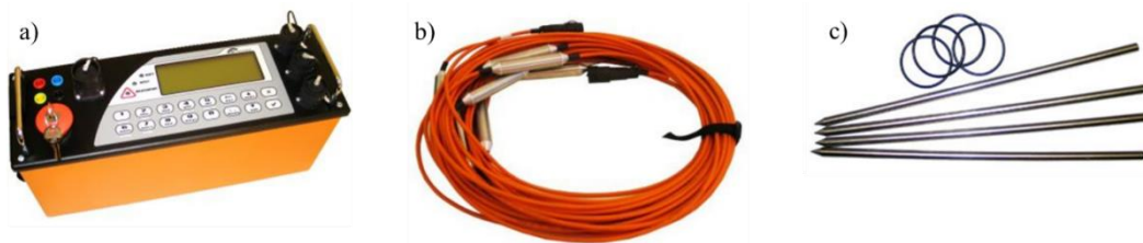
Obr. 9 a) Řídící jednotka ARES b) aktivní multielektrodové kabely MCS5 c) nerezové elektrody, (gfinstruments.cz 20.5.2022).
