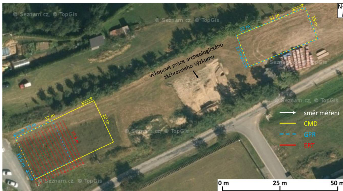
Obr. 10 Geofyzikální měření provedené na lokalitě s viditelným odkryvem záchraného archeologického průzkumu (mapy.cz); vlevo dolní, vpravo horní plocha; žlutě měření CMD, modře GPR, červeně ERT.
