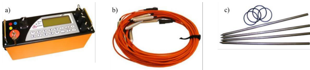
Obr. 9 a) Řídící jednotka ARES b) aktivní multielektrodové kabely MCS5 c) nerezové elektrody, (gfinstruments.cz 20.5.2022).
