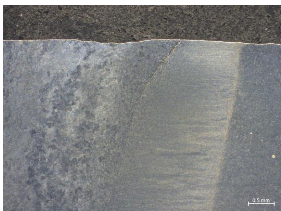
Obr. 37 Detail trhliny vzorku 1 (zvětšeno 20x)
