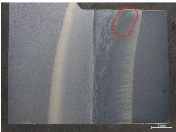
Obr. 35 Makrostruktura vzorku 1 (zvětšeno 6x)
