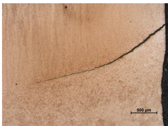
Obr. 39 Trhlina na vzorku 1 na přechodu mezi TMOO a TOO kostičky (zvětšeno 50x)
