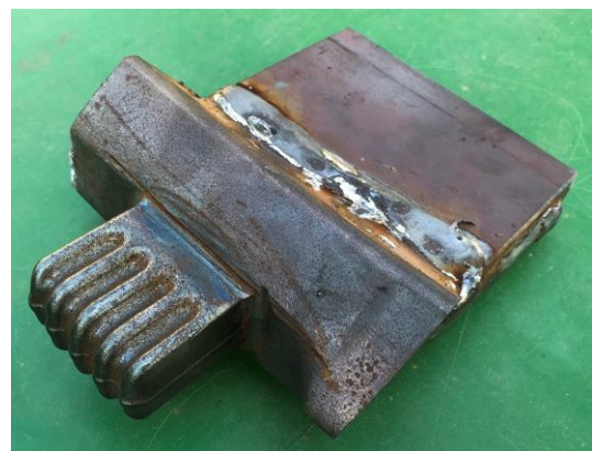
Obr. 25 Úprava svařence pro zkoušku rozlomením
