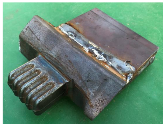
Obr. 25 Úprava svařence pro zkoušku rozlomením
