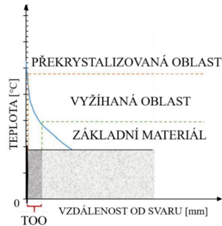
Obr. 12 Schéma velikosti TOO u svařování třením [20]
