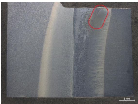
Obr. 35 Makrostruktura vzorku 1 (zvětšeno 6x)
