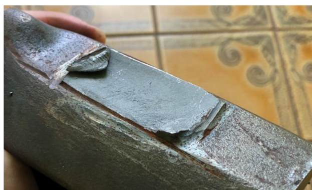
Obr. 51 Příčník po rozlomení
