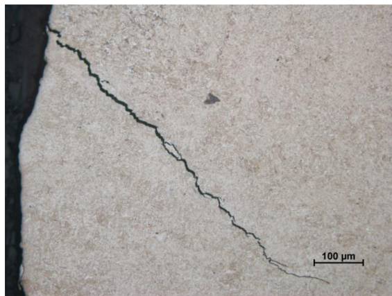
Obr. 40 Trhlina na vzorku 2 na přechodu mezi TMOO a TOO kostičky (zvětšeno 200x)
