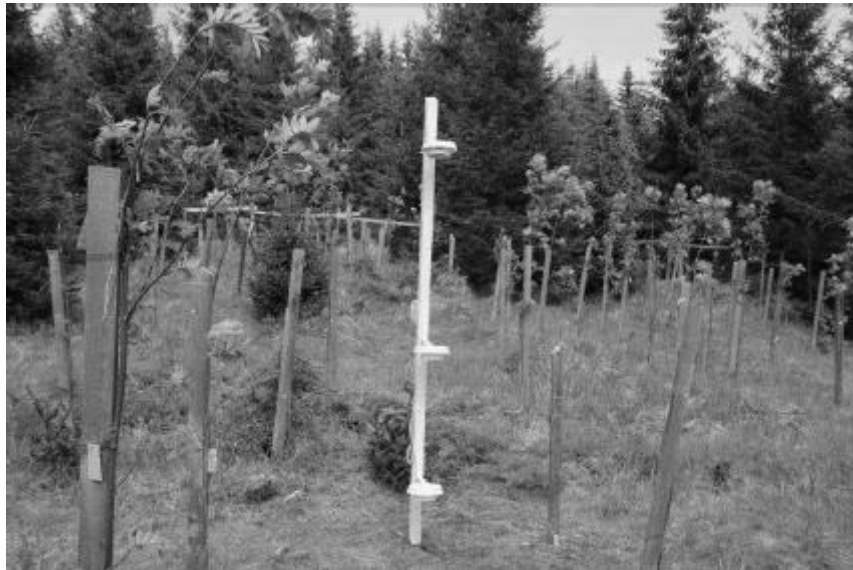
Obr. 9: Čtyřkanálový datalogger umístěný v terénu (NOVÁKOVÁ 2013).
