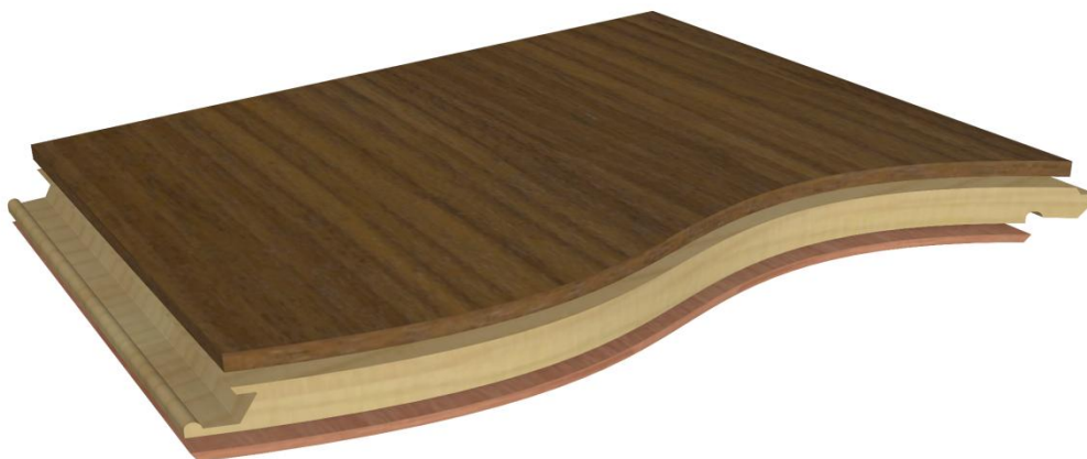
Obr. 2. Vizualizace skladby třívrstvé dřevěné podlahy
