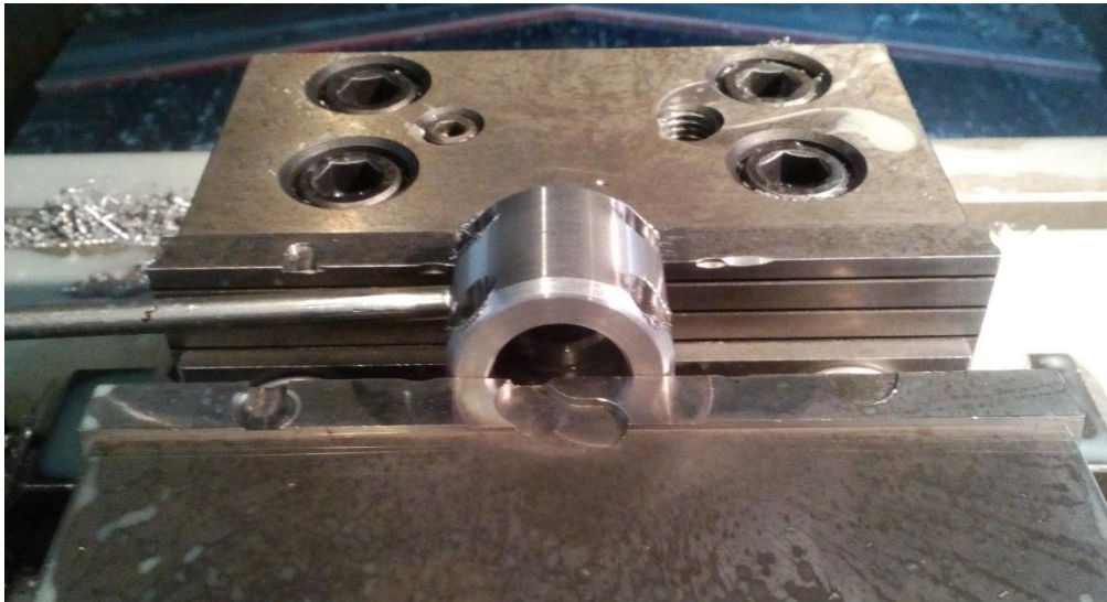
Obr. 2.10 Upnutí obrobku a umístění dorazu.
