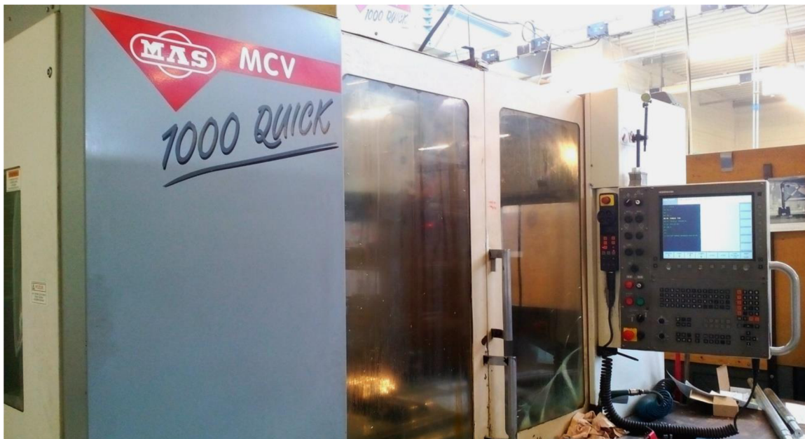
Obr. 2.2 CNC frézovací a vrtací centrum MAS Kovosvit MCV 1000 QUICK.
