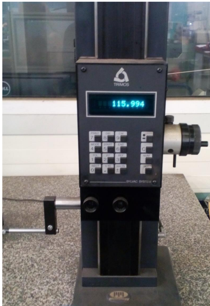
Obr. 2.5 Výškoměr Trimos Vertical 3 TVA 600.
