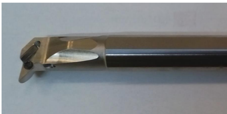
Vnitřní soustružnický nůž Mitsubishi FSVUC1612R-08A
