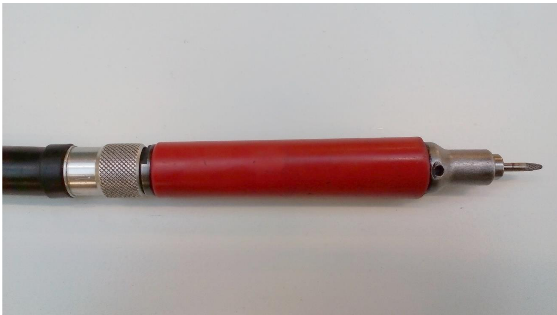
Obr. 2.4 Pneumatická bruska Suhner LSA 77-XT.
