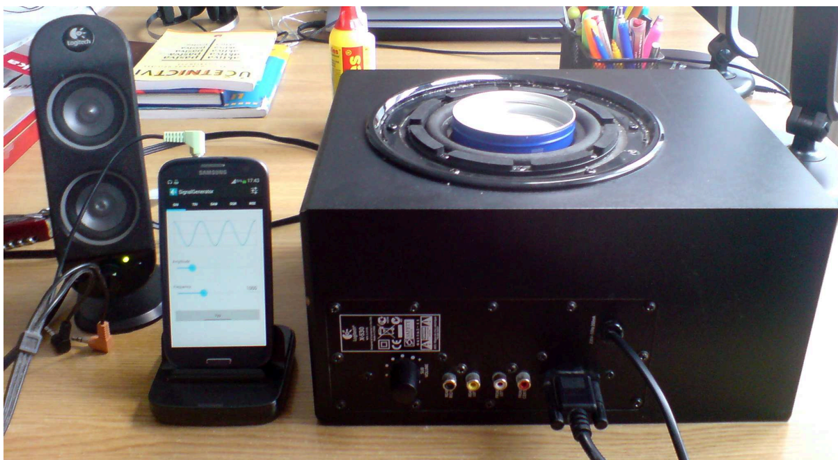
Obrázek 25: Příklad realizace experimentálního zařízení v domácích podmínkách. Vibrace jsou na kapalinu přenášeny prostřednictvím misky přilepené k membráně subwooferu lepicí páskou. Zdrojem signálu je mobilní telefon. Signál je do subwooferu přiveden přes pravý satelit, kde je vypínací tlačítko. Zesilovač je zabudován v ozvučnici, jedná se tedy o aktivní sestavu.
