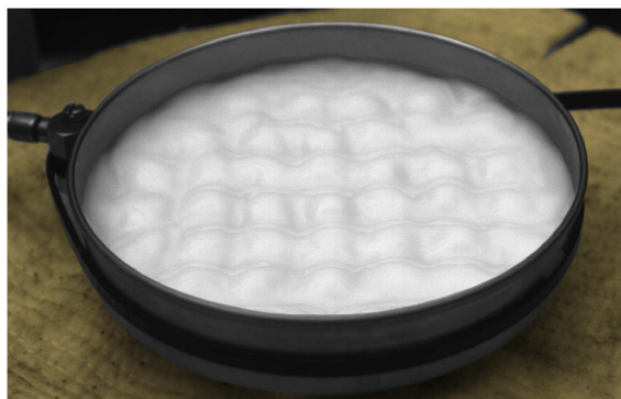
Obrázek 12: a) pruhové vlny na hladině motorového oleje při 62 Hz, b) čtvercové vlny na hladině roztoku mléka a vody (cca 1:1) při 32 Hz.
