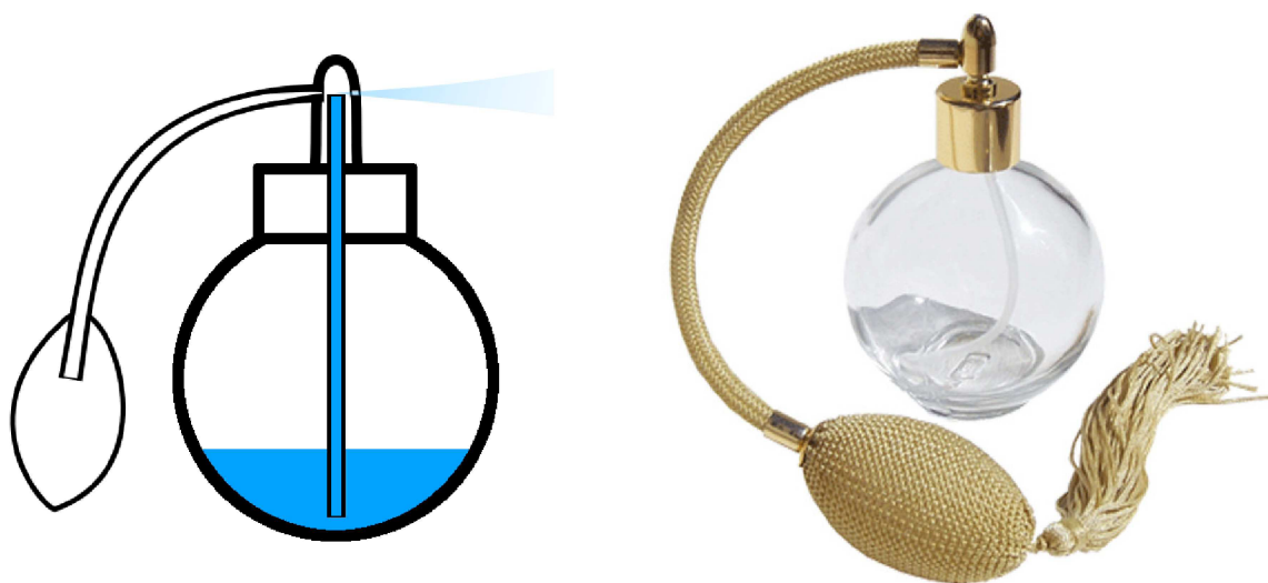
Obrázek 13: Parfém s atomizérem. Vlevo je schématický náčrt, vpravo skutečné provedení. Zdroj: http://www.essentialatomizer.com .
