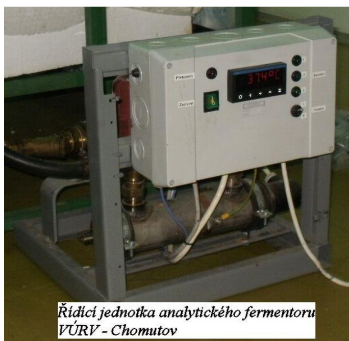
Obrázek 18 : Řídící jednotka modelového laboratorního fermentoru – autor
