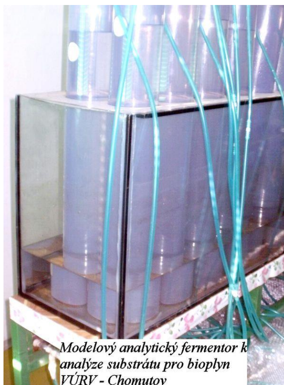
Obrázek 20 : Modelový analytický fermentor v laboratoři VÚRV Chomutov – autor
