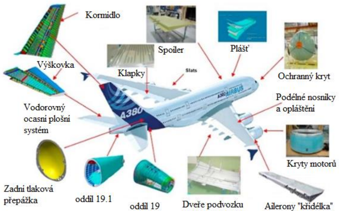
Obrázek 38. Aplikace lepení přilnavostí na letadle Airbus A380. [21]
