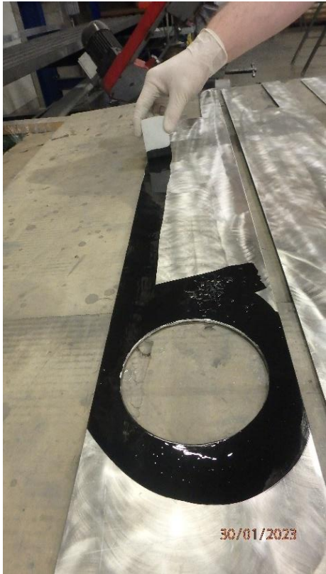
Obrázek 23. Nanášení Primeru na plech Obrázek 24. Schnutí nátěru
