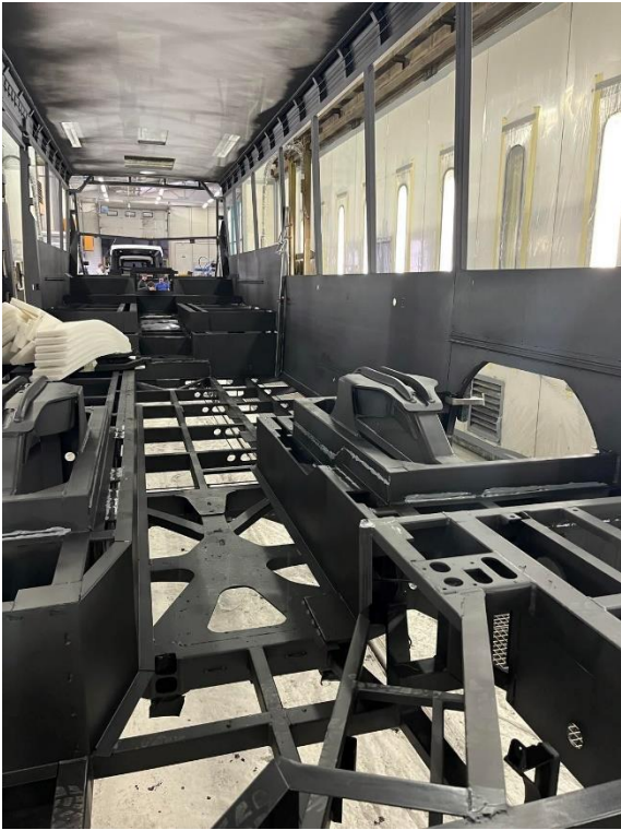
Obrázek 36. Svařovaná karoserie Obrázek 37. Lepený segment podlahy
