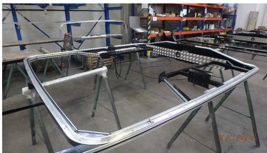
Obrázek 13. Olištovaný rám měchu kloubového autobusu
