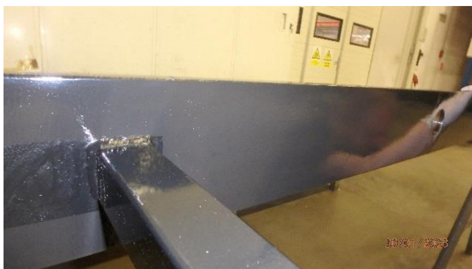
Obrázek 22. Nanášení Primeru na rám
