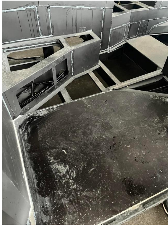
Obrázek 36. Svařovaná karoserie Obrázek 37. Lepený segment podlahy
