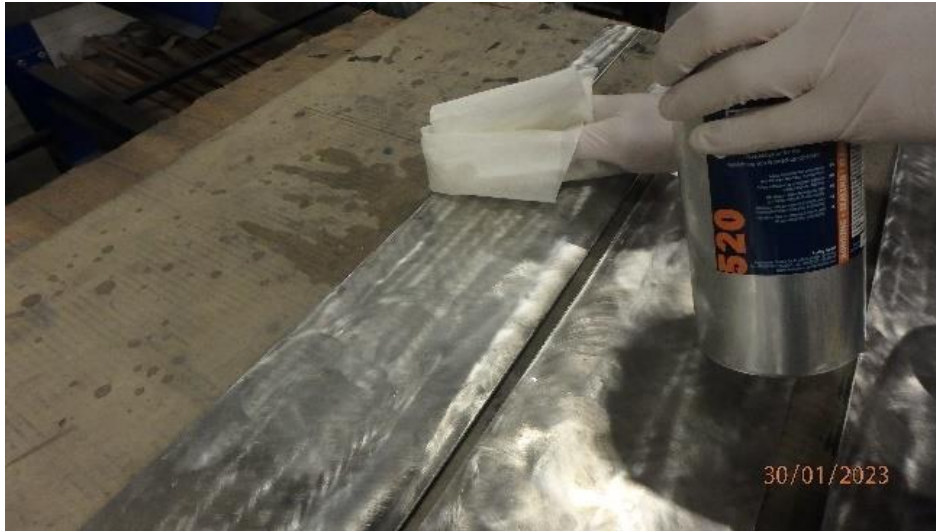
Obrázek 18. Čištění povrchu plechu
