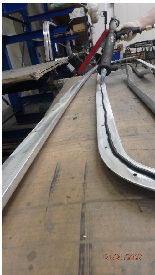
Obrázek 11. Nanášení lepidla na lišty
