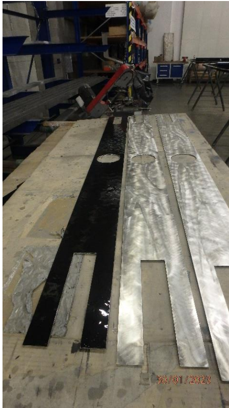
Obrázek 23. Nanášení Primeru na plech Obrázek 24. Schnutí nátěru
