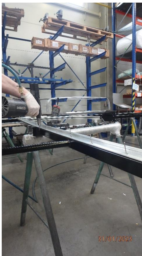
Obrázek 12. Nýtování lišt k rámu
