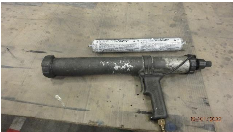
Obrázek 27. Vzduchová aplikační pistole s lepidlem
