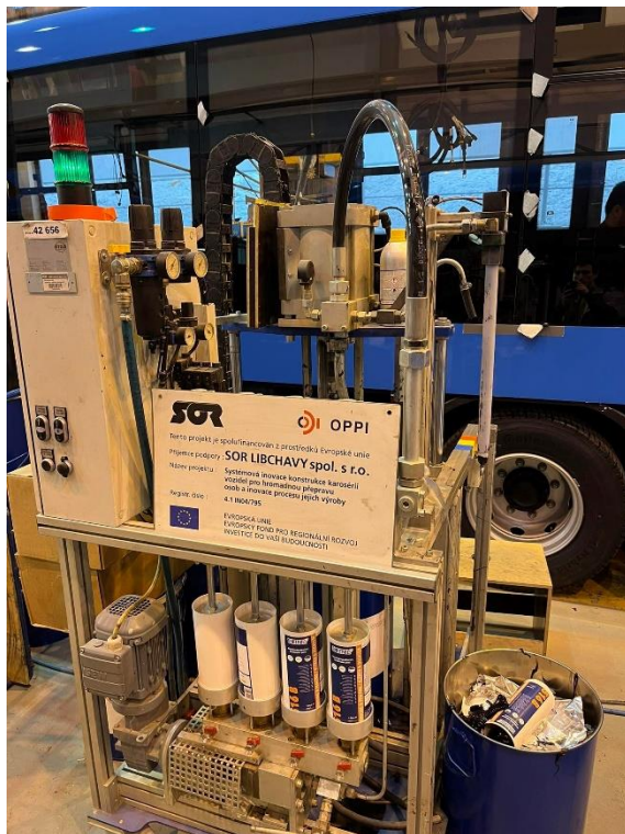
Obrázek 25. Mísící zařízení na přípravu lepidla
