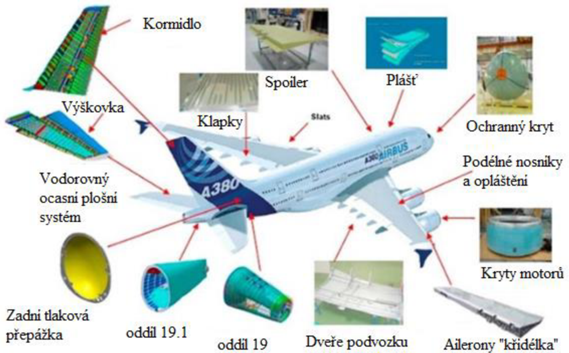
Obrázek 38. Aplikace lepení přilnavosti na letadle Airbus A380. [21]
