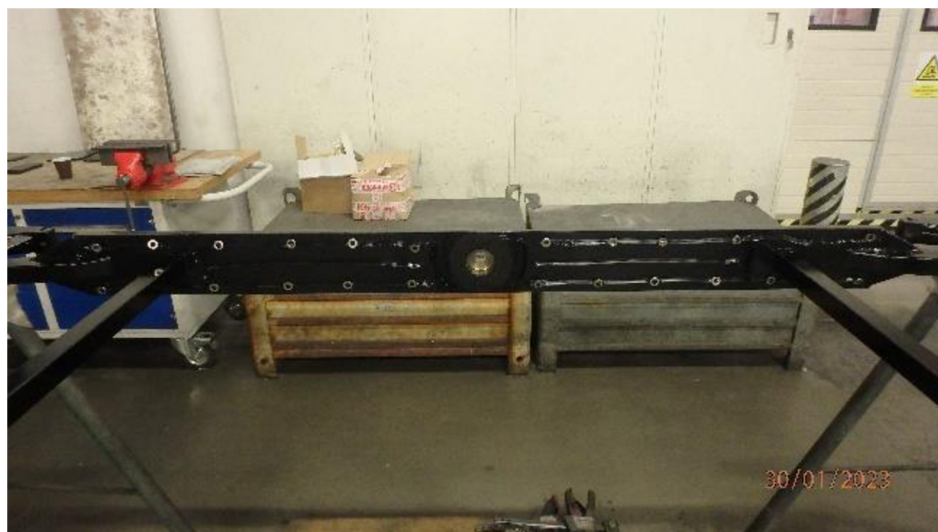
Obrázek 29. Zajištění tloušťky vrstvy pomocí podložek
