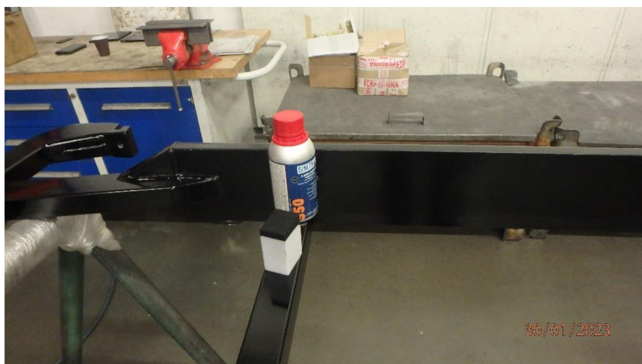
Obrázek 21 Primer se nanáší na oba povrchy
