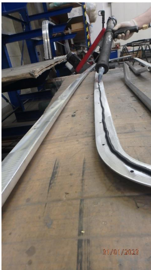
Obrázek 11. Nanášení lepidla na lišty
