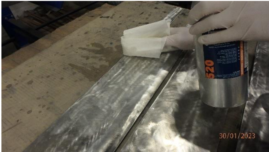
Obrázek 18. Čištění povrchu plechu
