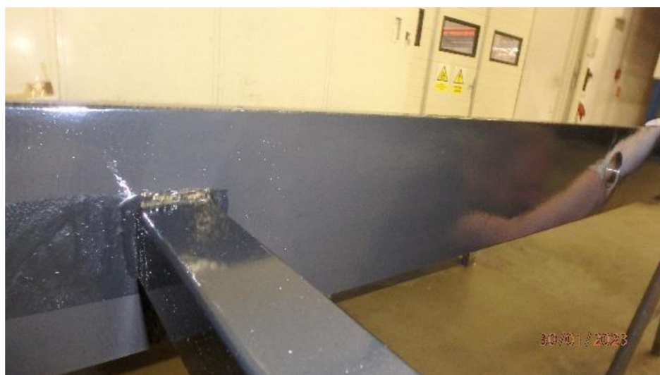
Obrázek 22. Nanášení Primeru na rám
