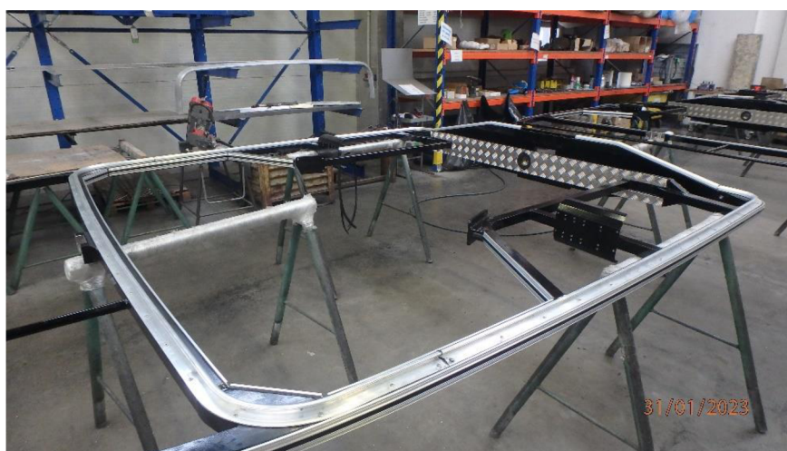
Obrázek 13. Olištovaný rám měchu kloubového autobusu
