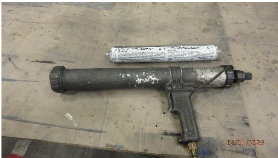
Obrázek 27. Vzduchová aplikační pistole s lepidlem
