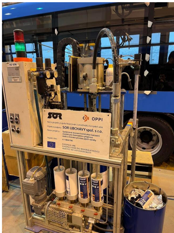
Obrázek 25. Mísicí zařízení na přípravu lepidla
