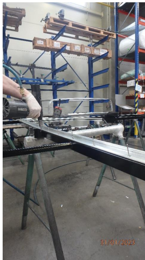
Obrázek 12. Nýtování lišt k rámu
