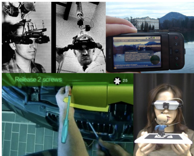
Obrázek 2.1: Vlevo nahoře Ultimate Display I. Sutherlanda, vpravo nahoře navigace s rozšířenou realitou od Wikitude , vlevo dole servisní manuál pro auta značky BMW s rozšířenou realitou – pohled přes speciální brýle, lokalizace markeru ve scéně a vykreslení virtuálního objektu pomocí aplikace ARToolkit.
