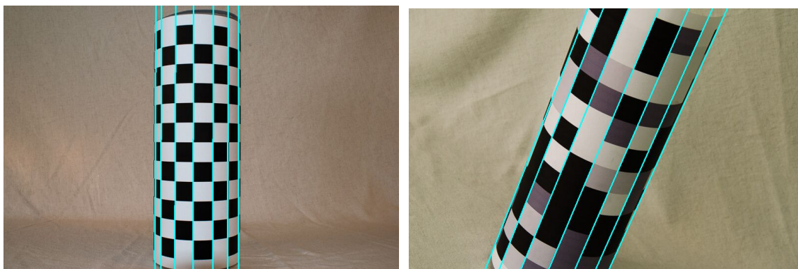
Obrázek 5.6: Ukázka shlukování finálních přímek. Finální přímký jsou zobrazeny světle modře.
