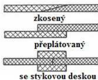
Obr. 17 Základní typy lepených spojů, [10]
