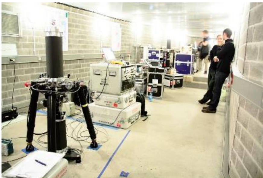
Obr. 6 srovnávací měření absolutních gravimetrů ECAG 2011 ve Walferdange
