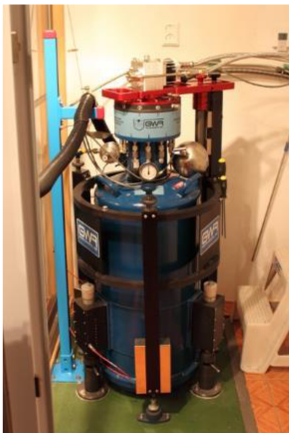
Obr. 7 supravodivý gravimetr GWR OSG-050 ve slapové stanici Pecný
