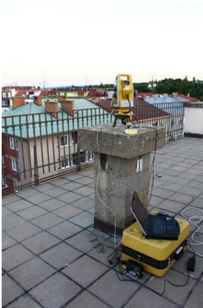
Obr. 9 kompletní systém MAAS-1 během přípravy observace
