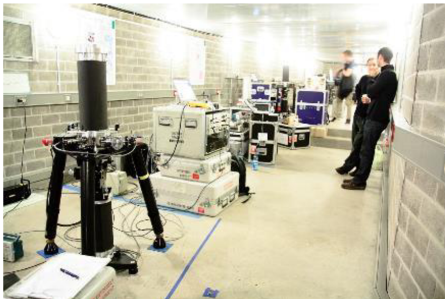
Obr. 6 srovnávací měření absolutních gravimetrů ECAG 2011 ve Walferdange
