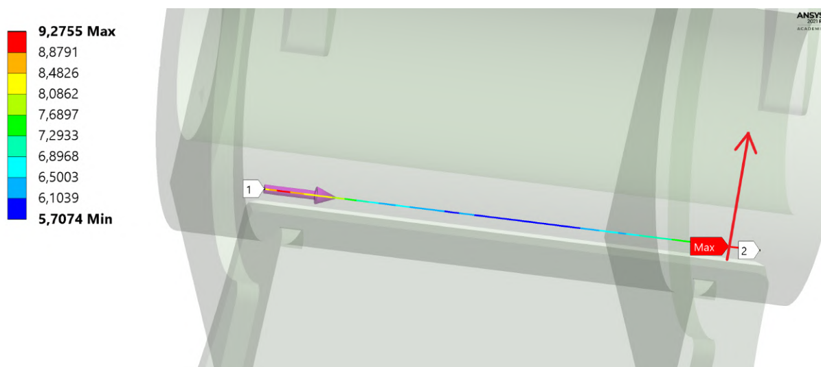
Obrázek 4.55: Vykreslení hlavního napětí \sigma_1 po cestě a naznačení cesty pro odečtení napětí
