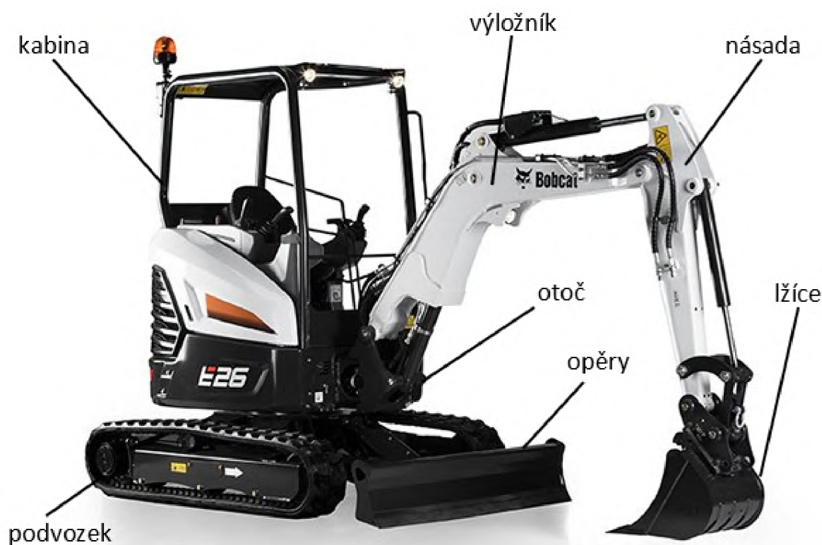
Obrázek 1.1: Kompaktní rýpadlo, ilustrační obrázek [4]
