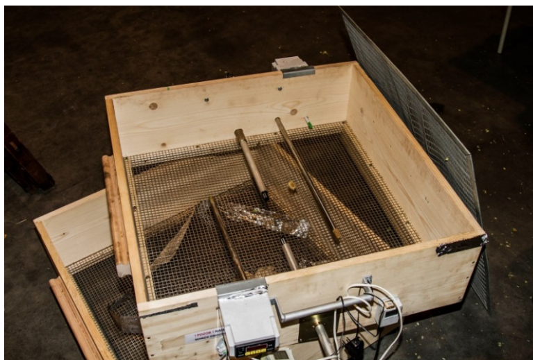
Obr. 11 Líska se zabudovanými sondami a sítovým dnem (Zdroj: Rybka et al. 2017)
