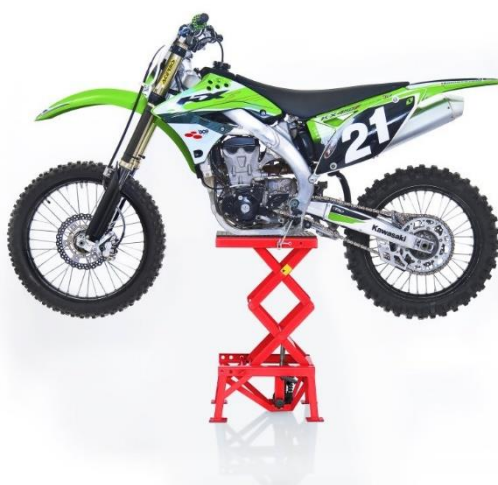
Obr. 9 Motocyklový zvedák s připevněním za rám [8]
