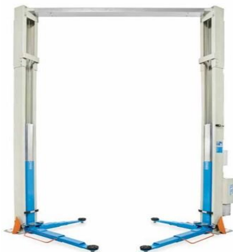
Obr. 5 Dvousloupový zvedák s horním rámem [4]
