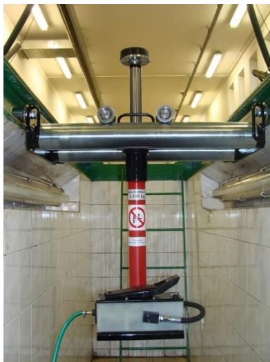
Obr. 11 Jámové zvedací zařízení [10]
