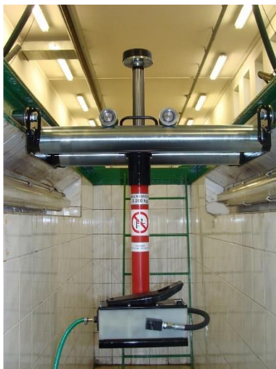
Obr. 11 Jámové zvedací zařízení [10]
