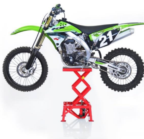
Obr. 9 Motocyklový zvedák s připevněním za rám [8]
