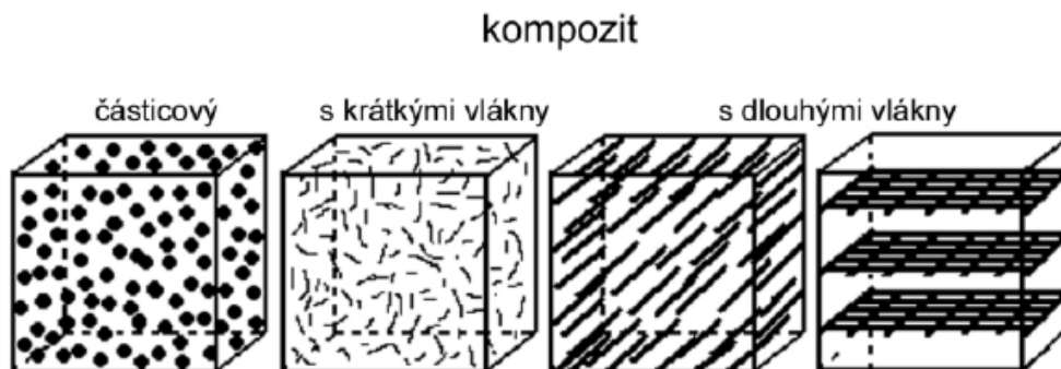
Obrázek 8: Dělení kompozitů podle tvaru výztuže [42]
