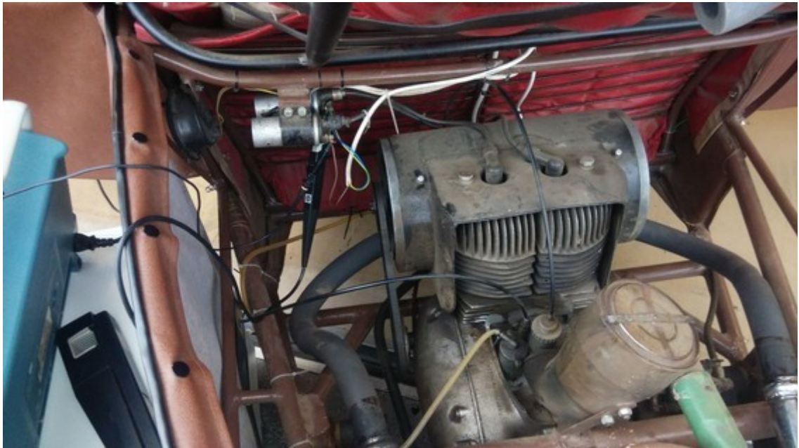
Obr. 16: Detail motorového prostoru Velorexu a připojení měřících sond na cívky zapalování
