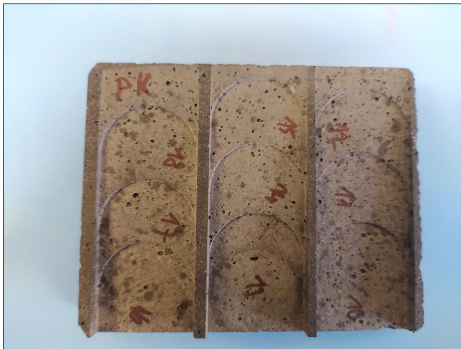
Obr. 38 Bublínky na povrchu pryskyřice s recyklovanými uhlíkovými vlákny
