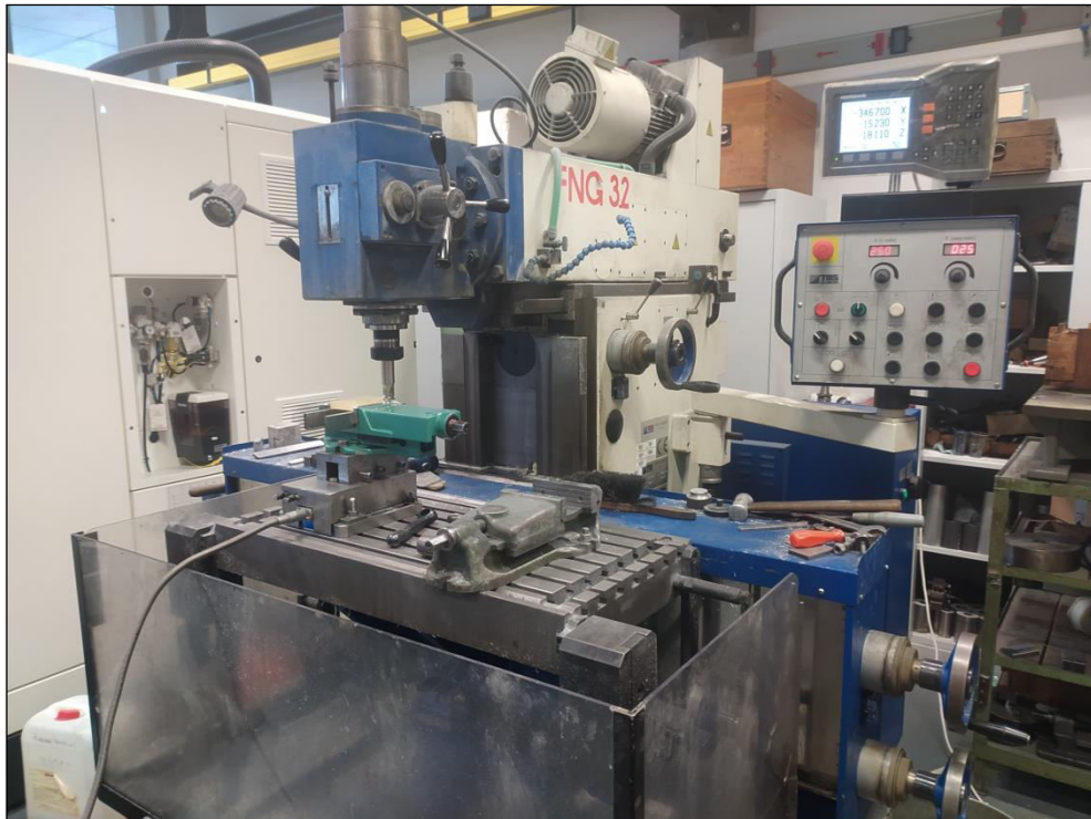
Obr. 19 Univerzální konzolová frézka FNG 32
