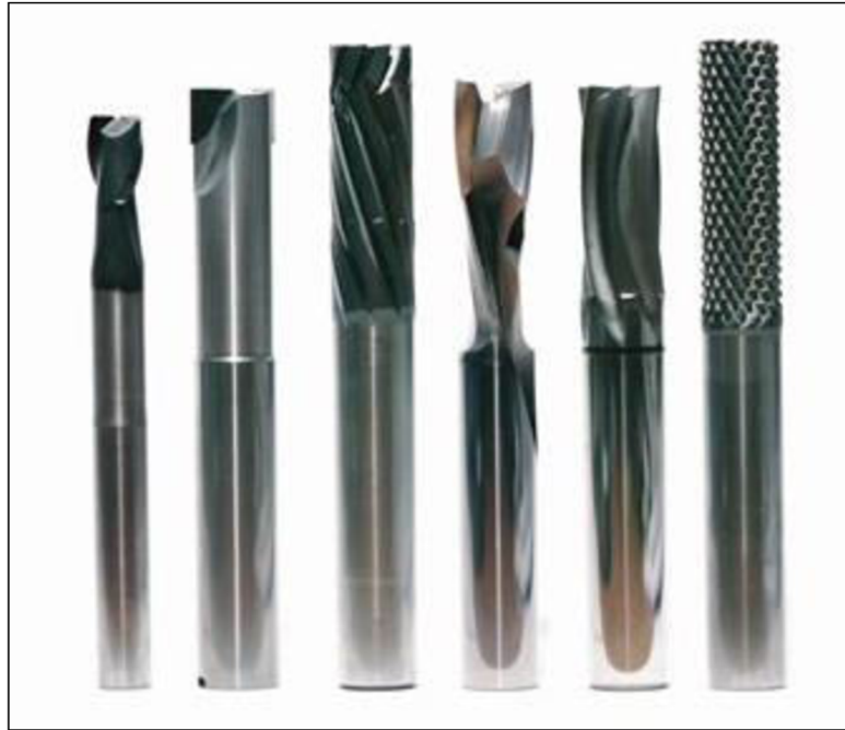
Obr. 8 Druhy fréz různých tvarů a geometrií pro frézování kompozitů [4]
