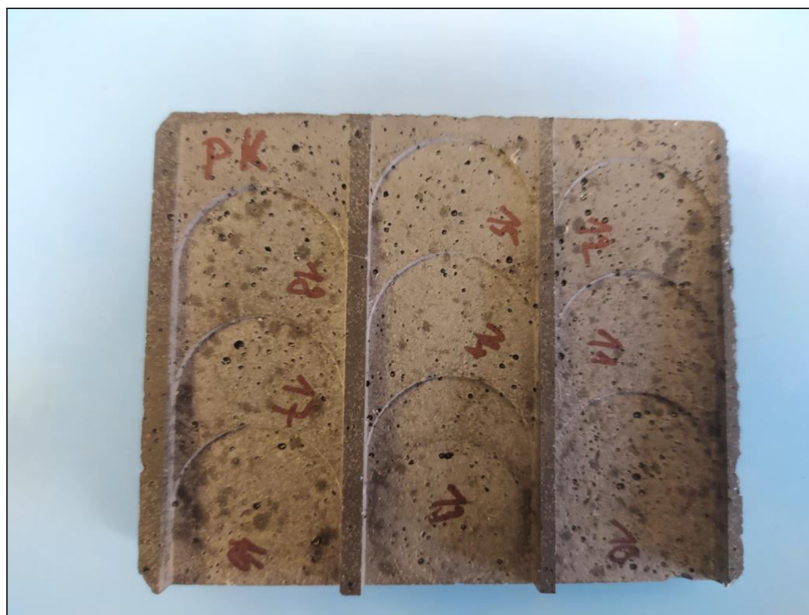
Obr. 38 Bublínky na povrchu pryskyřice s recyklovanými uhlíkovými vlákny
