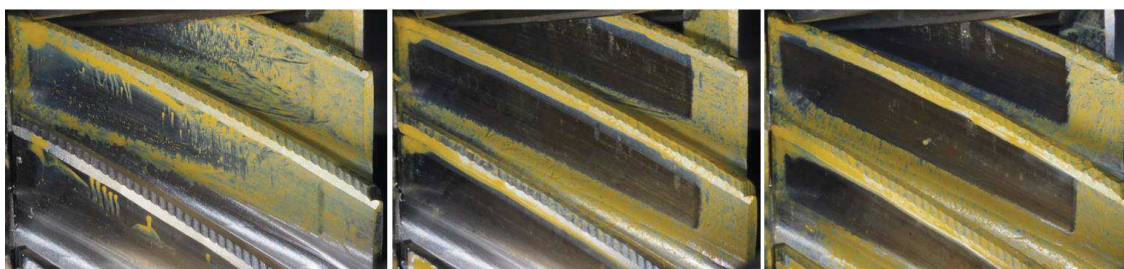
Obr. 8.7: Otisky zubů 2. rychlostního stupně (zleva 0, 50, 100 Nm) hnací kolo
