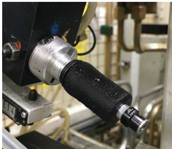
Obr. 7.1: Jednoosý snímač vibrací na zabíhacích stavech
