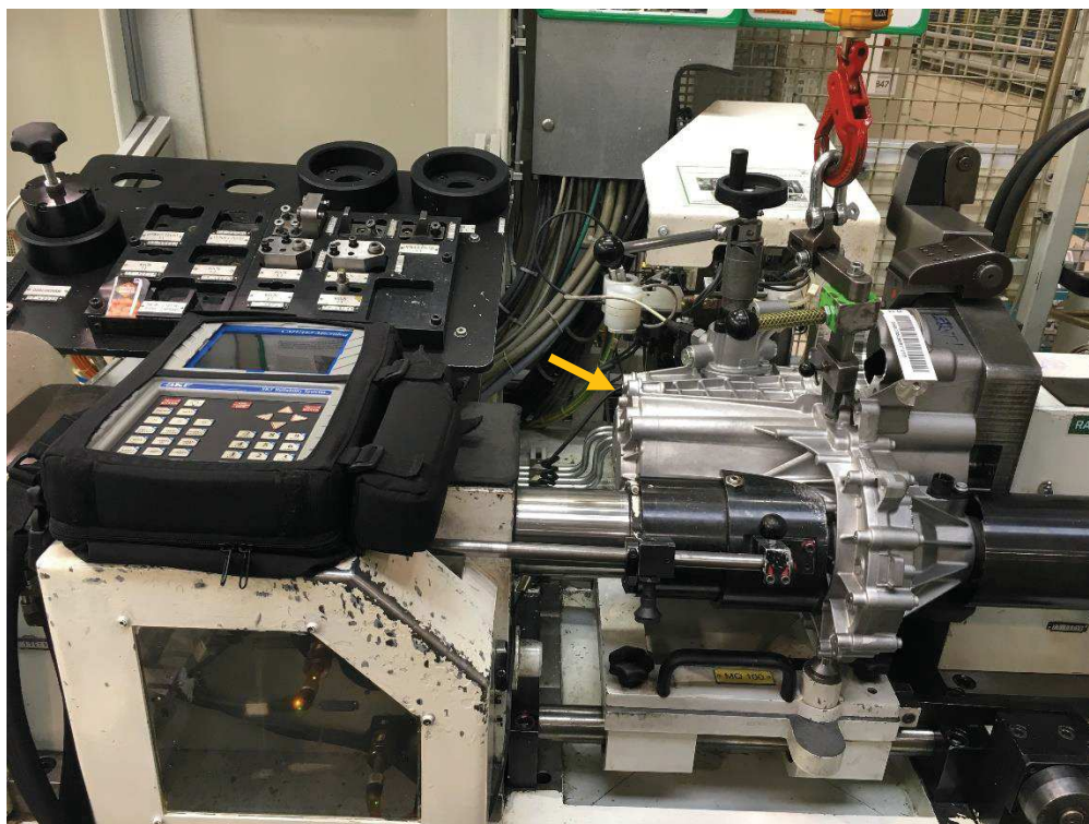
Obr. 4.4: Upevnění převodovky na zabíhací stavy
