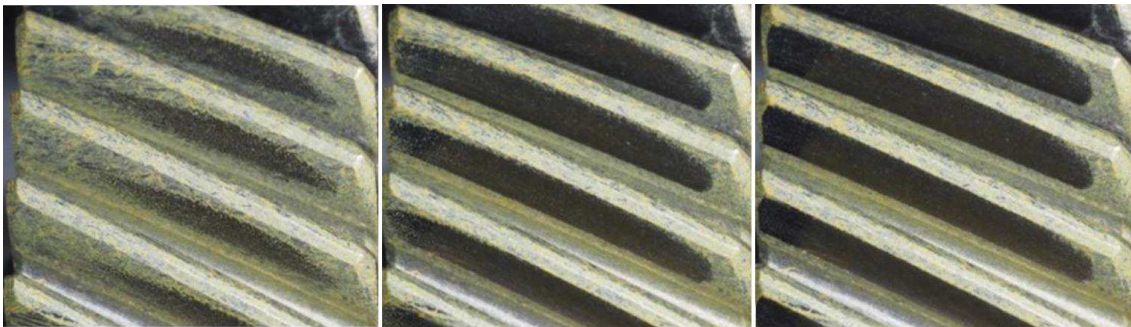
Obr. 8.8: Otisky zubů 5. rychlostního stupně (zleva 0, 50, 100 Nm), hnací kolo
