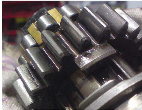
Obr. 2.4: Ozubené kolo poškozené pittingem
